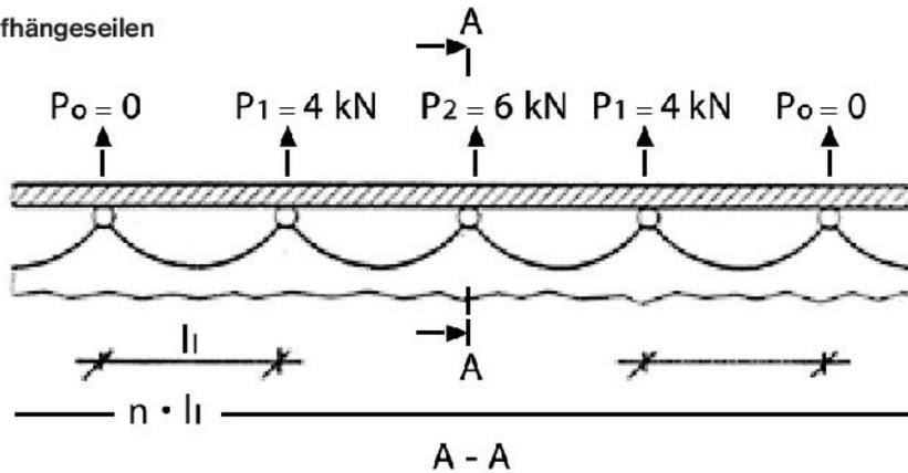
Schutznetze Typ S sind an Bauwerksteilen mit Aufhängeseilen zu befestigen.
