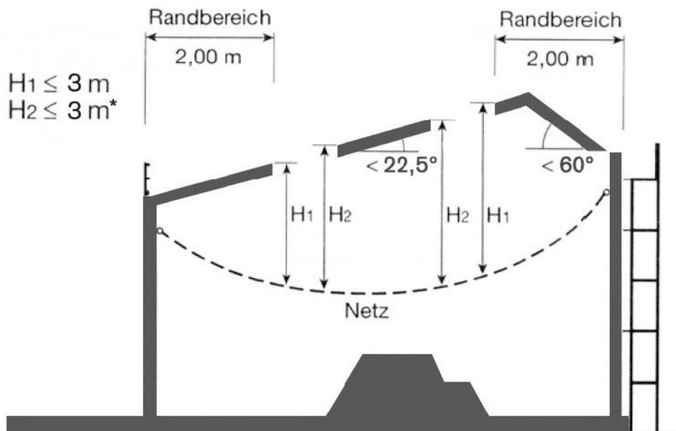
\* Das Material der Schutznetze (Sicherheitsnetze) nach DIN EN 1263-1 ist für abstürzende Personen aus einer Höhe von maximal 6,0 m ausgelegt.
