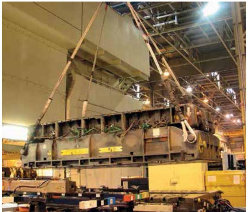
**Anschlagseile aus Dyneemafasern • Tragfähigkeiten von 10 t - 400 t**
